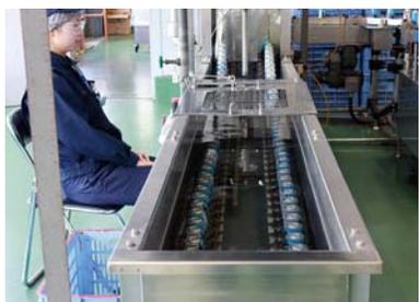
充填が終わったガス缶は、缶を加温してガス漏れの目視検査を行った後、ウェイトチェッカーで全数重量検査を行う。
